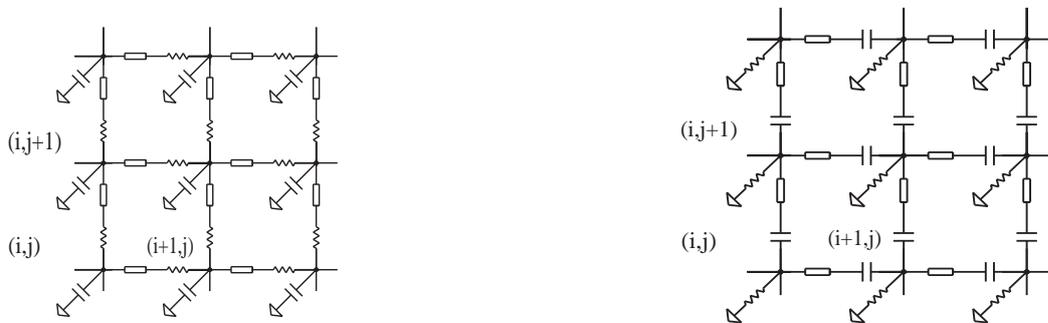
Рис. 5. Фрагменты большой сети  $RLC$  контуров, зашунтированных через емкости (слева) или индуктивности (справа).
